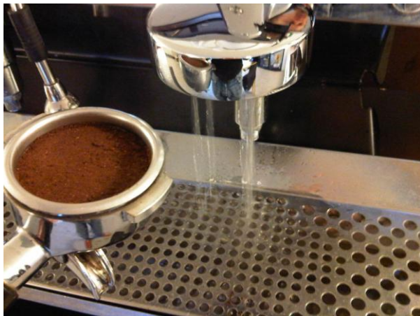
Afb.: voor het zetten, de groep even kort spoelen voor vers en heet water
